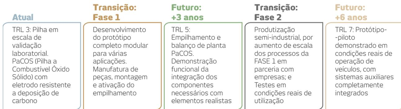
Figura 7 – Fases de desenvolvimento do PAT para veículos a pilha a combustível a etanol
